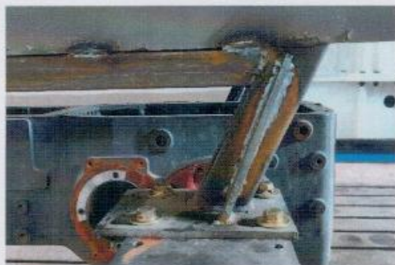
图 2 防翻架后部左侧安装于后桥壳体的形式 (侧 视)
