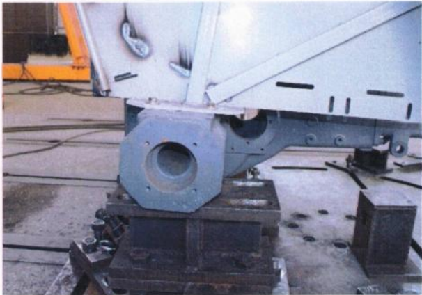
图 3 防翻架右侧安装于后桥壳体的形式 (侧 视)
