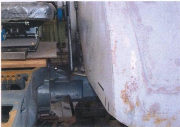
图 2 防翻架左侧安装于后桥壳体的形式 (前 视)
