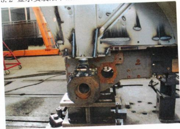
图 2 驾驶室后部右侧安装于后桥壳体的形式 (侧 视)
