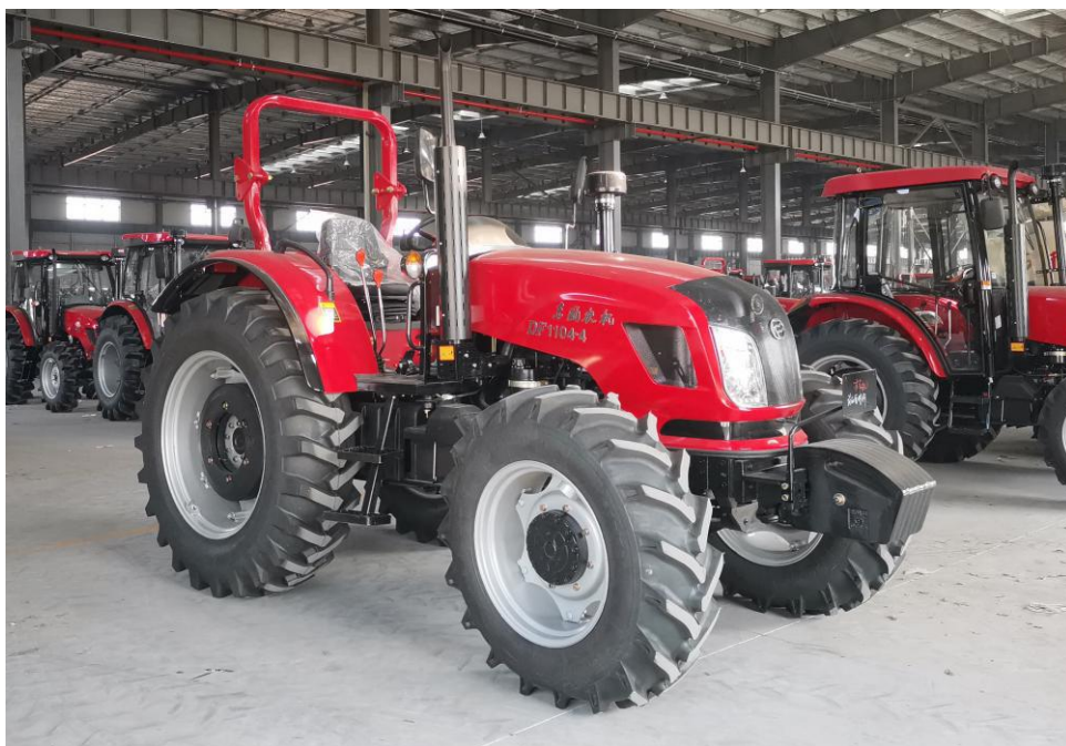
图 4 同单元机型 DF1104-4 型轮式拖拉机（安全架）
