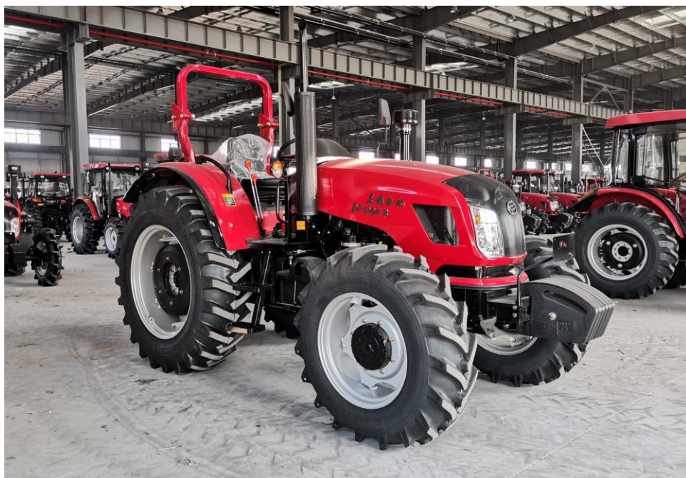
图2 DF1204-8 型轮式拖拉机（安全架）
