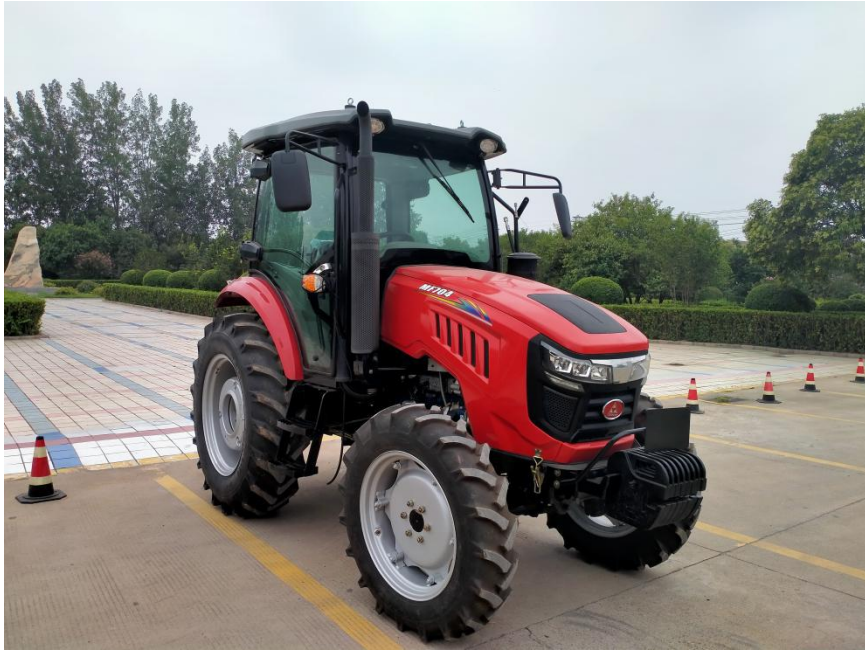
MF704 型轮式拖拉机（选装驾驶室）
