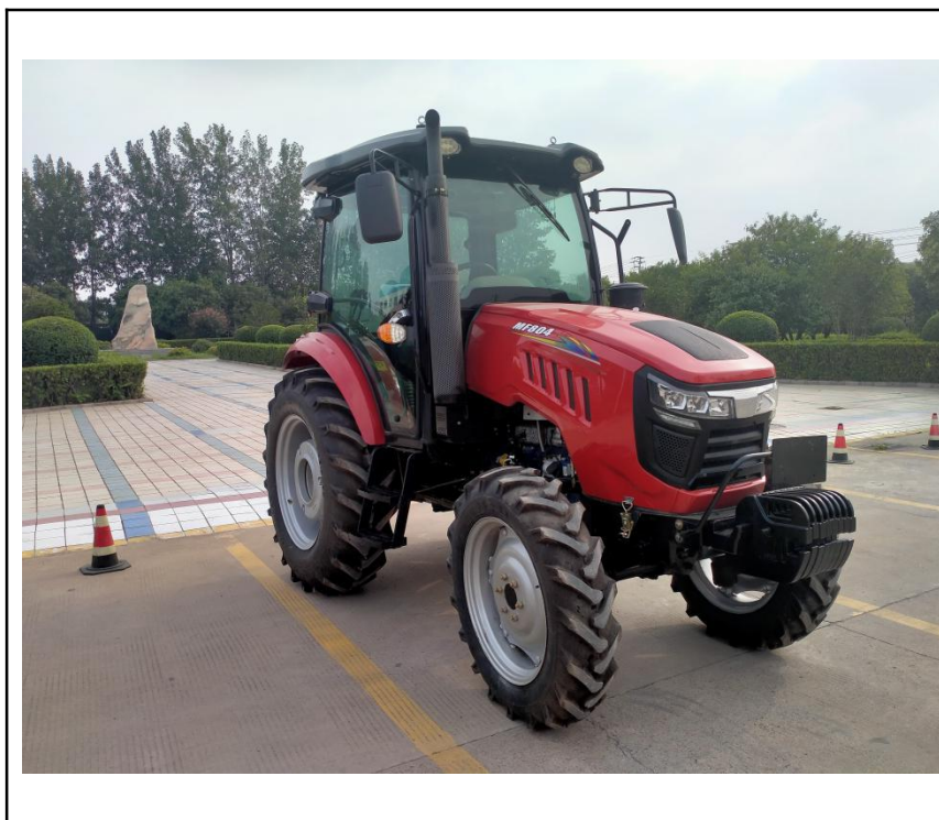
MF804 型轮式拖拉机（选装驾驶室）
