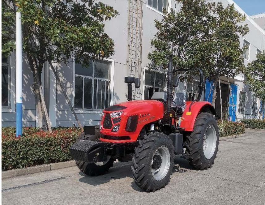
DF1004-X (G4) 型轮式拖拉机（配置安全框架）
