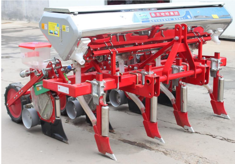
2BYFSF-4 型玉米免耕施肥精播机
