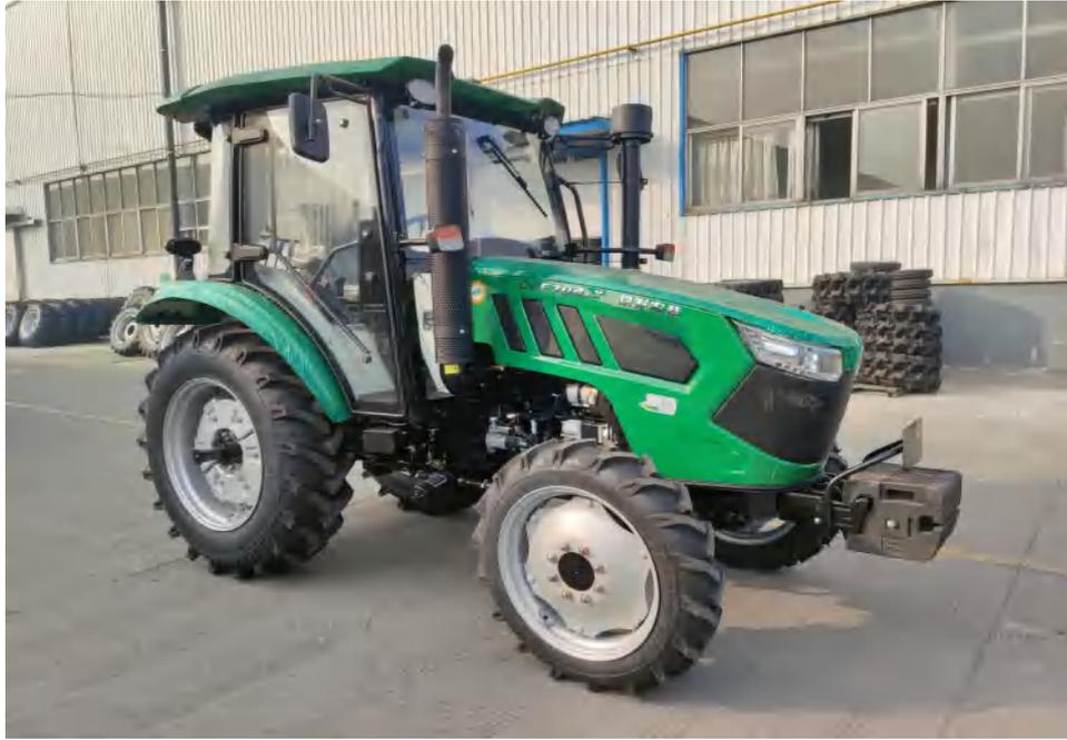
CFE704-X 型轮式拖拉机（选装 40106064550010 型简易驾驶室）
