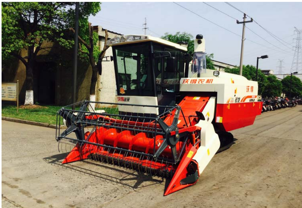
4LZ-6.0MD 型履带自走全喂入式谷物联合收割机
