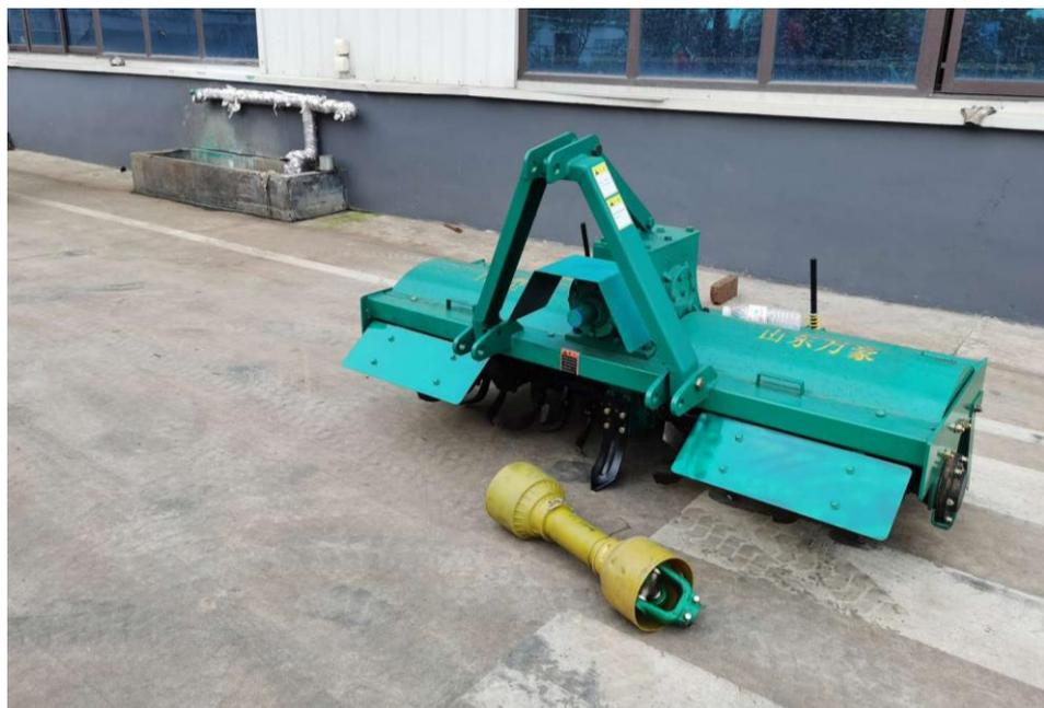
涵盖机型：1GKN-150 型单轴旋耕机
