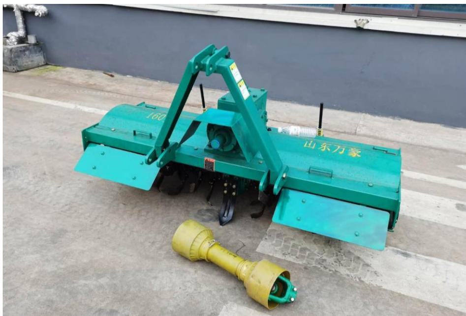
涵盖机型：1GKN-160 型单轴旋耕机
