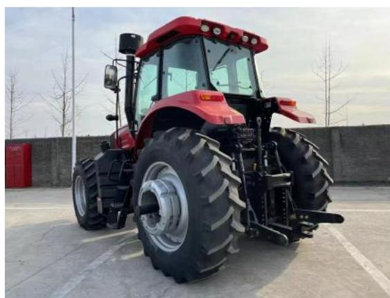
LX2004 型轮式拖拉机（选装 LR6M3LR22/1475 型柴油机）
