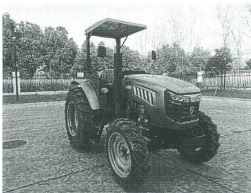
FJ904 型轮式拖拉机（选装安全框架）
