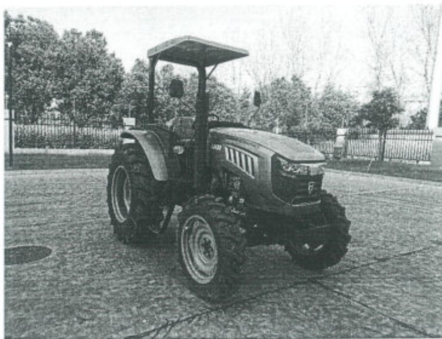
FJ804 型轮式拖拉机（选装安全框架）
