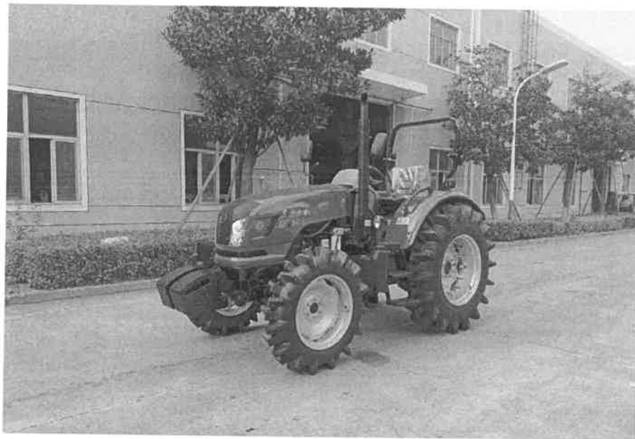
DF804-9 型轮式拖拉机（配置 454J. 46. 001 安全框架）
