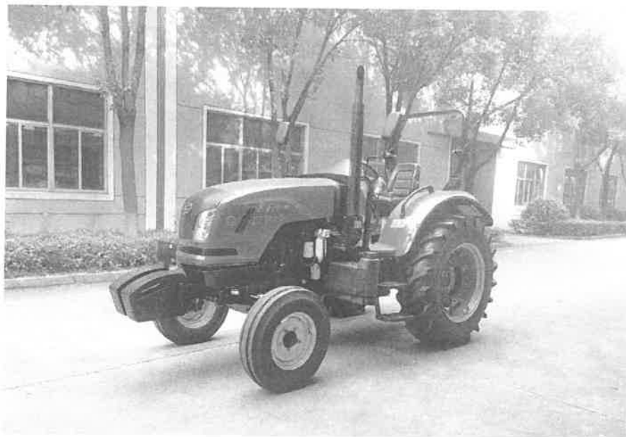
DF800-9 型轮式拖拉机（配置 454J.46.001 安全框架）
