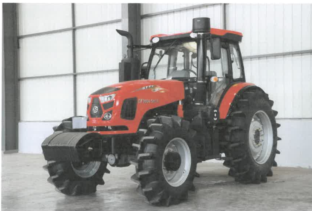
自主变更 3：机罩外形和前照灯变更后（选装）
