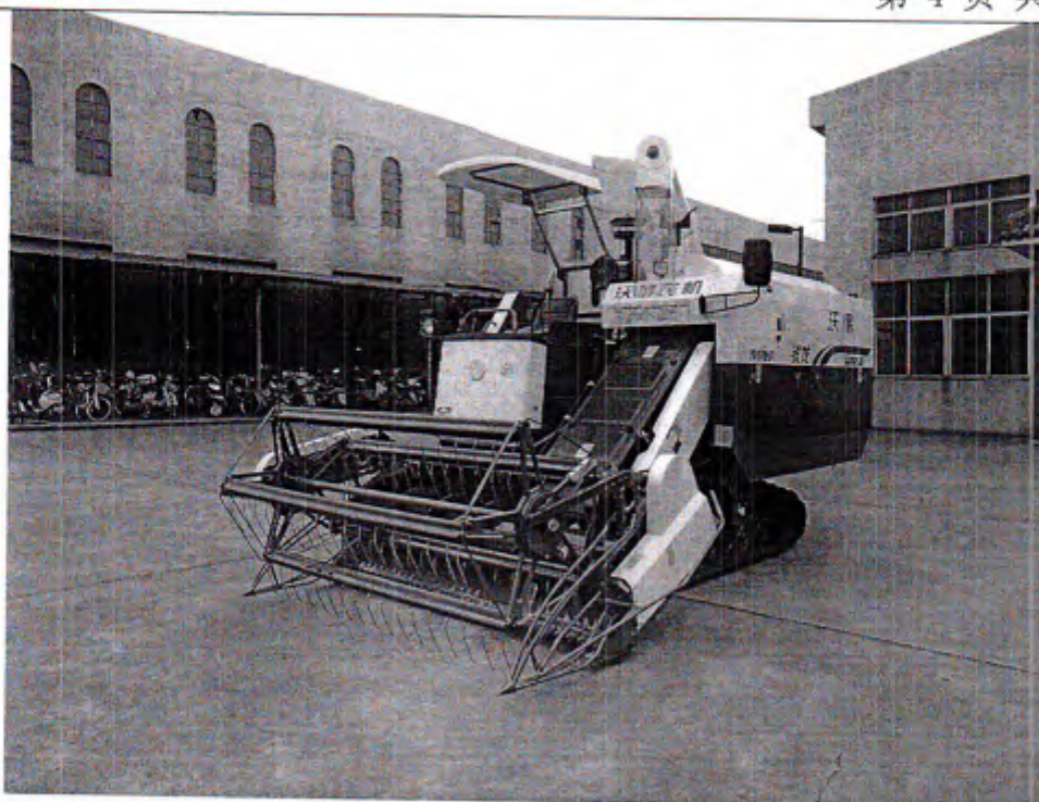
4LZ-6.0EKG 型履带自走全喂入式谷物联合收割机
