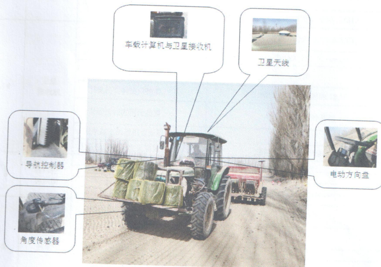
Trimble AG EZ-Pilot RTX BD-2.5SD型自动驾驶(电动方向盘式)
