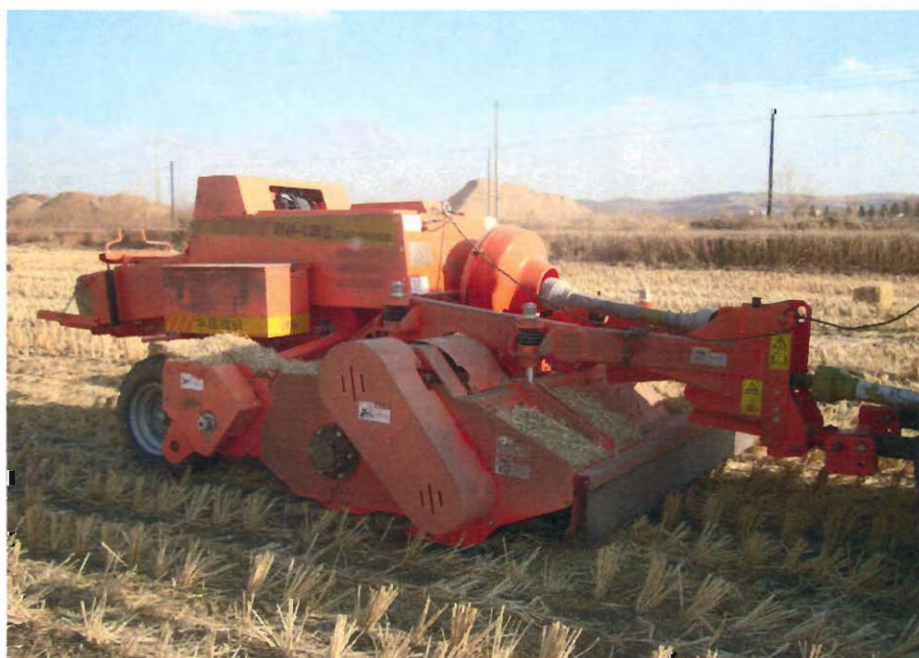
9YJS-2.2B 型双刀轴秸秆切割揉碎方捆压捆机
