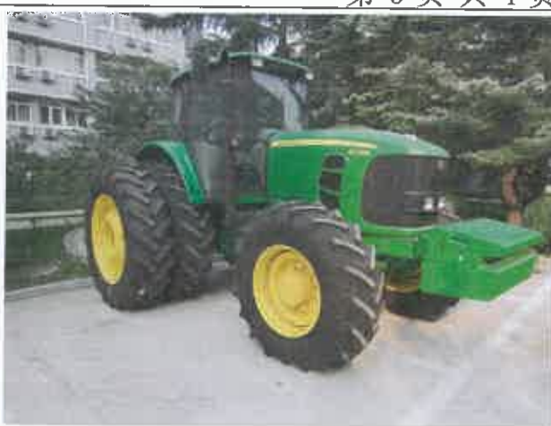
JD2104 型轮式拖拉机配置 20F+20R 变速箱的产品特征见下图:
