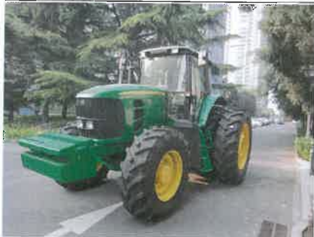
JD2104 型轮式拖拉机配置 20F+20R 变速箱的产品特征见下图:
