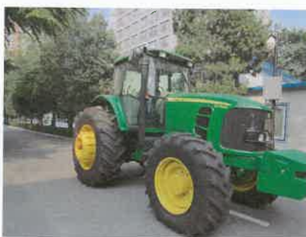
JD2104 型轮式拖拉机配置 20F+20R 变速箱的产品特征见下图:
