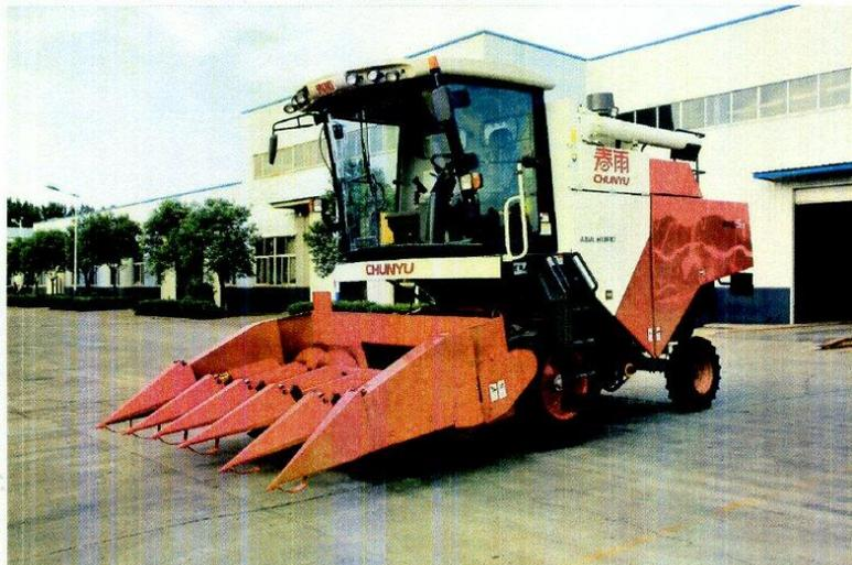
4YZL-5H 型自走式玉米籽粒联合收获机
