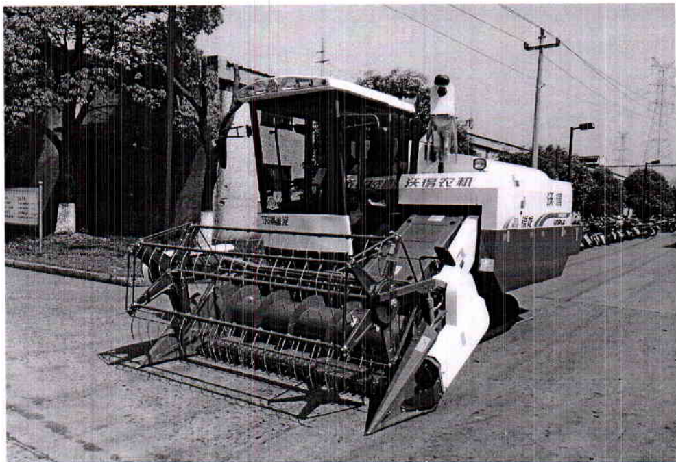
4LZ-6.0MD 型履带自走全喂入式谷物联合收割机
