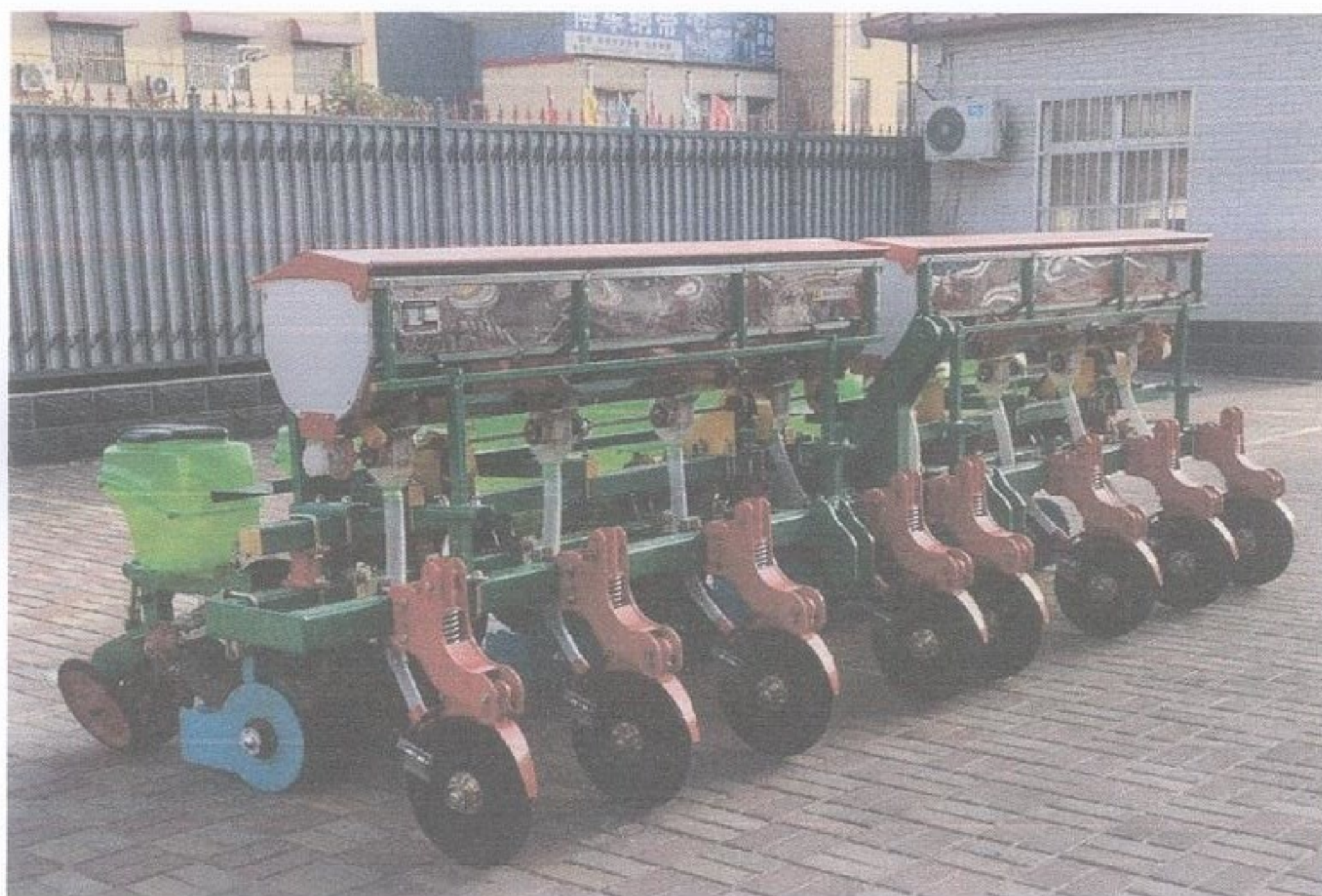
2BMFZY-8Y 型玉米免耕施肥播种机
