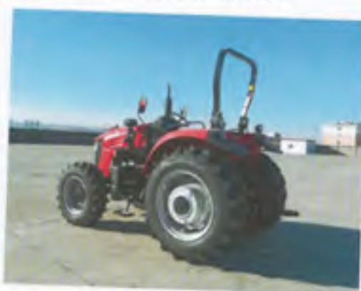
LX804 型轮式拖拉机 (配置 LY1104-3-46-002 型安全框架)
