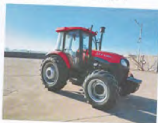
LX804 型轮式拖拉机 (配置 LX704-3-45-001 型简易驾驶室)
