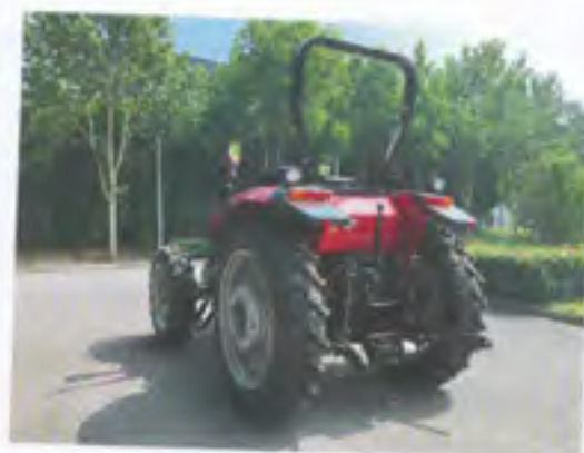
LX804 型轮式拖拉机 (配置 LX954. 47. 011 型安全框架)
