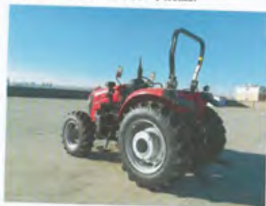
LX904 型轮式拖拉机(配置 LY1104-3-46-002 型安全框架)
