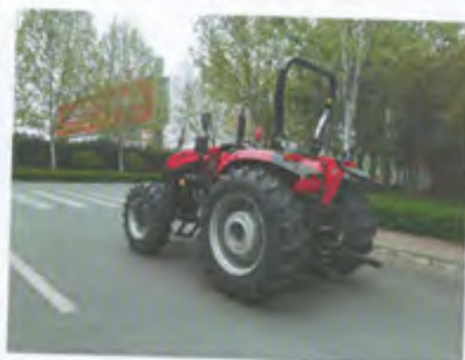
LX754 型轮式拖拉机 (配置 LX954.47.011 型安全框架)
