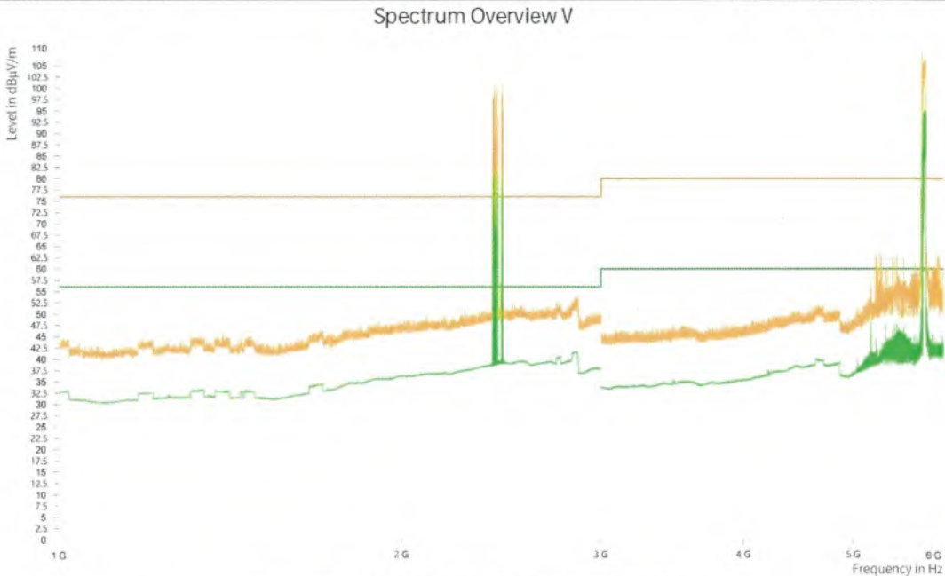
1GHz~6GHz 辐射骚扰测试结果图 (垂直极化)
